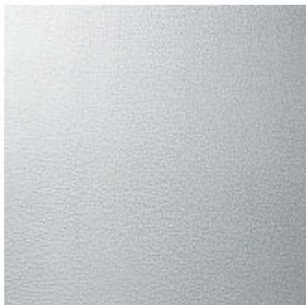
Beschichtung mit Primalon Seiden-Latex nach 3D grau 15 getönt.
